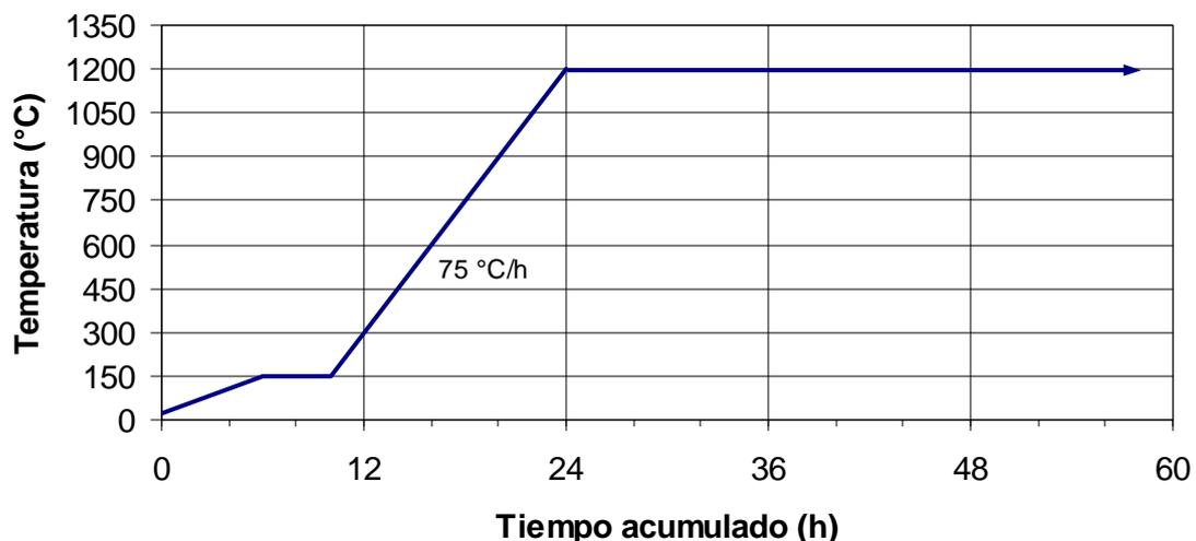
Temperatura final: 1200 °C      Espesor total de todos los refractarios no secados: 100 mm
