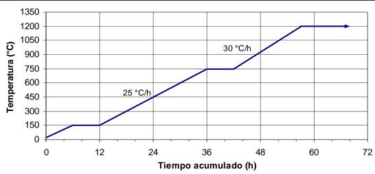
Temperatura final: 1200 °C Espesor total de todos los refractarios no secados: 100 mm Para espesores mayores de 100 mm, aumentar 1,5 h. o disminuir la rampa 0,6 °C/h en el intervalo de150 a 750 °C por cada 10 mm adicionales
