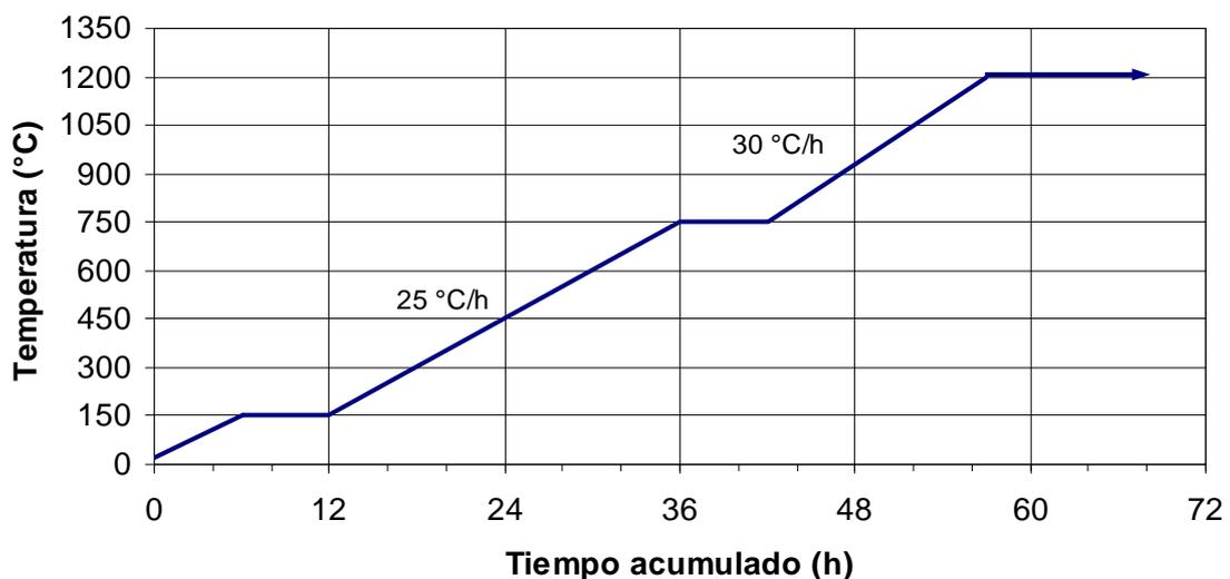
Temperatura final: 1200 °C      Espesor total de todos los refractarios no secados: 100 mm
